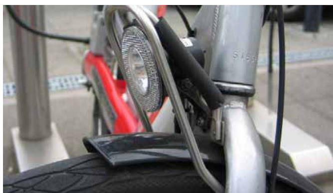
Joonis 28: Robustne esituli jalgrataste ühiskasutuskeemi „DB Call a bike” rattal
