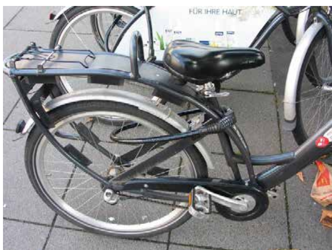
Joonis 34: Nextbike rattalukk, Frankfurt (Saksamaa) (lihttehnoloogiline ühiskasutussüsteem)
